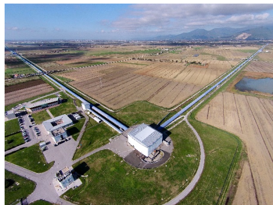
Vista aérea del detector de ondas gravitacionales Virgo, situado en Cascina, cerca de Pisa (Italia). Virgo es un interferómetro láser con brazos de 3 kilómetros de longitud. (Crédito de la imagen: Nicola Baldocchi / Colaboración Virgo.)
